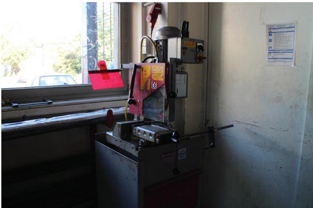
*Das ist eine Metallkreissäge, sie kann Metall schnell sägen.*
